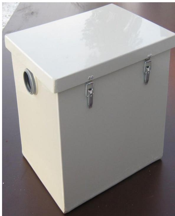
**Жироуловитель** – устройство для гравитационной очистки сточных вод от животных и растительных жиров. Типовой жироуловитель является секционированной ёмкостью, в которой происходит охлаждение и седиментация жиросодержащей жидкости. Охлажденные жиры переходят из эмульгированного состояния в неэмульгированное, капли всплывают на поверхность зеркала воды, откуда впоследствии удаляется слой жира.
